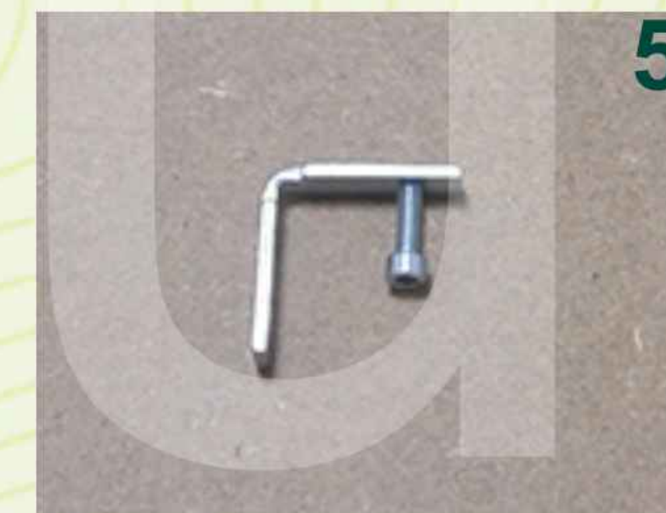
Подвижный стопор для придания заготовкам одинаковой длины.
