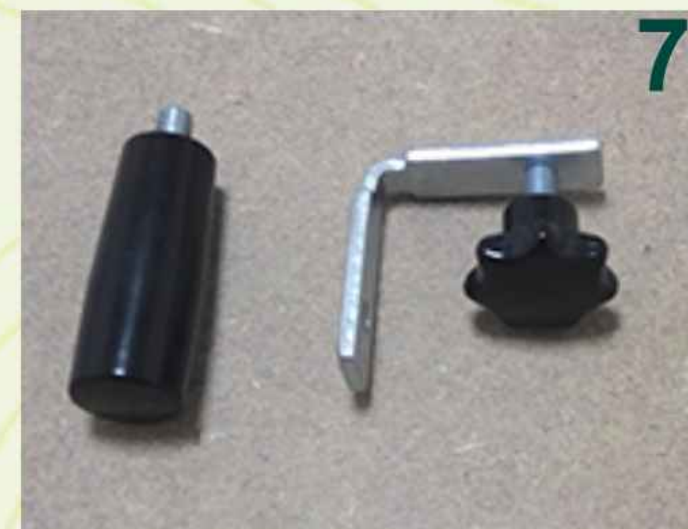
Рукоятки 2 шт. Опорная и для фиксации стопора (вместо винта под номером 5).
